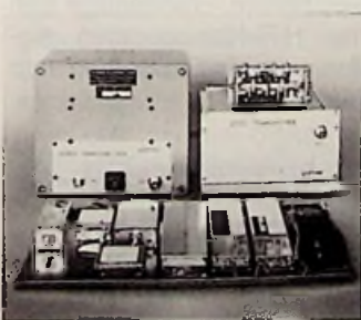
Bild 1: Im Vordergrund der Video-Empfänger in flacher Bauweise, im Hintergrund links ein Videosender, rechts ein solcher in Einschubtechnik, darüber die geöffnete Senderendstufe in Stripline-Technik
