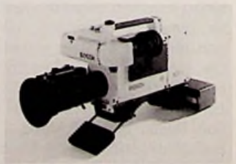
Bild 1: Portable Farbfernsehkamera für elektronische Außenproduktion und elektronische Berichterstattung (Bosch-Pressbild)
