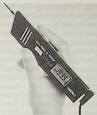
Bild 1: Digitalmultimeter für die Jackentasche (Brenner-Pressbild)
